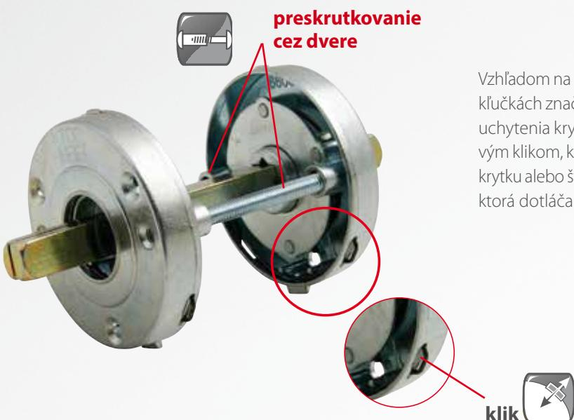
Vzhľadom na doterajšie skúsenosti a požiadavky zákazníkov sme pri kľučkách značky TUPAI v spolupráci s výrobcom zdokonalili systém uchytenia krytky rozety a štítu špeciálnym mechanickým pružinovým klikom, ktorý vám uľahčí namontovať a opäťovne demontovať krytku alebo štít bez poškodenia. V mechanike sa nachádza pružinka, ktorá dotláča krytku rozety alebo štít a zabráňuje jej vypadnutiu.
